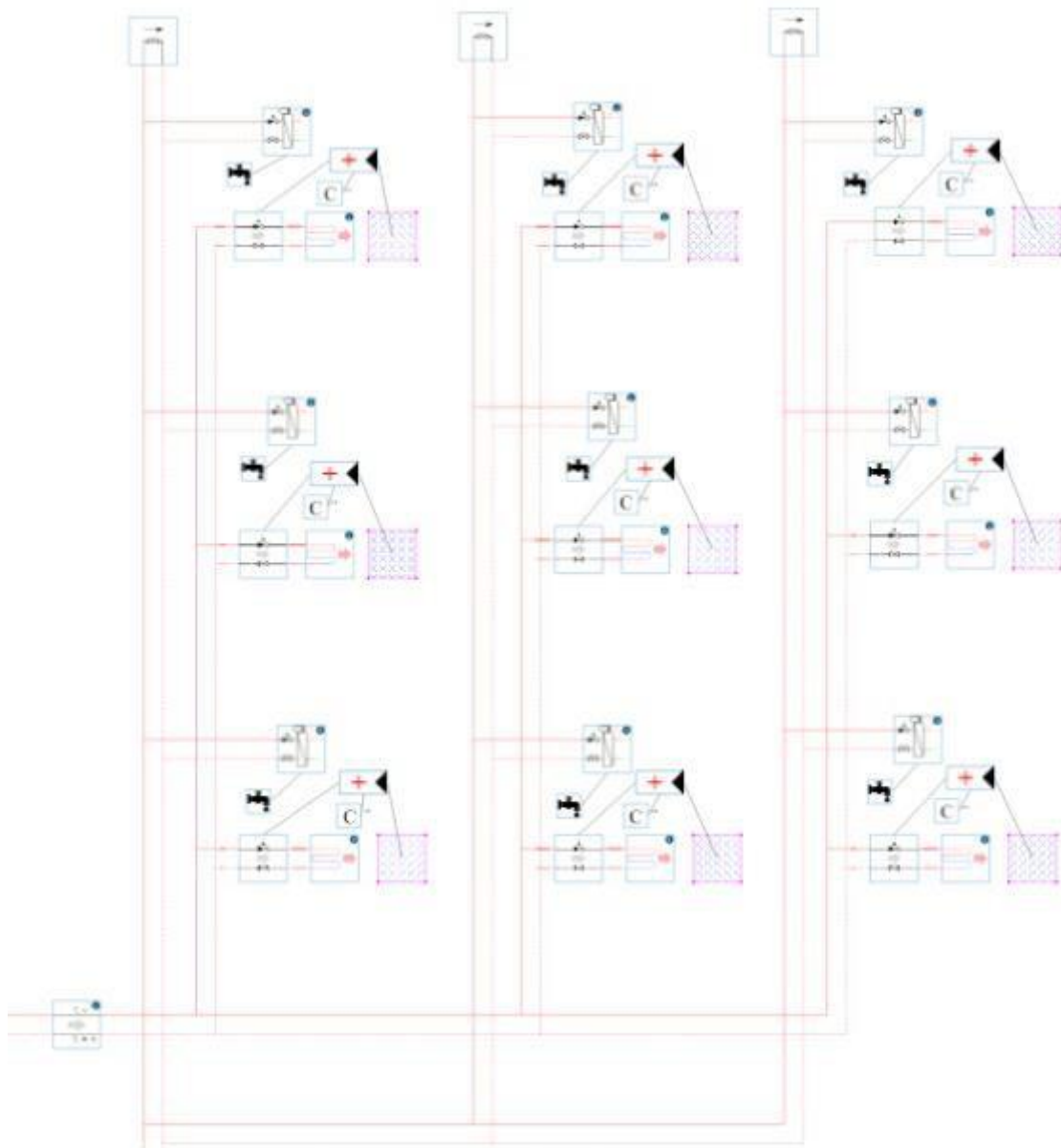
Figuur 37: aansluiting voor verwarming van de 9 appartementen
